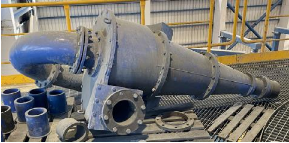
FIGURA 28: CICLONE PRIMÁRIO DESMONTADO
