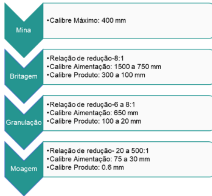
FIGURA 1: ESTÁGIOS DE FRAGMENTAÇÃO. FONTE: ADAPTADO DE (CHAVES, 2012)
