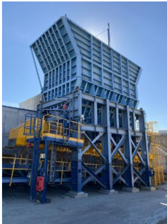
FIGURA 14: TORVA DE ALIMENTAÇÃO DO MOINHO AG/SAG COM ALIMENTADOR DE LAGARTAS
