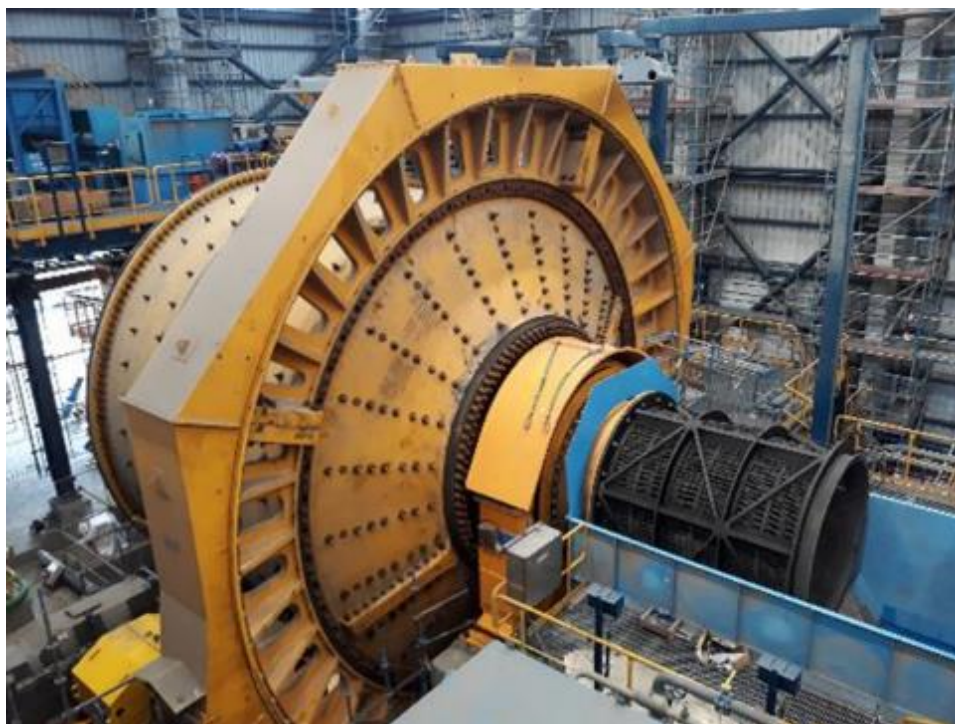
FIGURA 27: CRIVO GIRATÓRIO DA DESCARGA DO MOINHO
