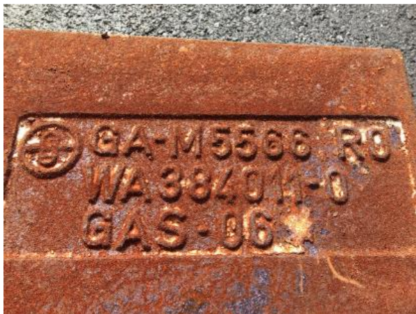
FIGURA 22: IDENTIFICAÇÃO DE UM COMPONENTE DE UM JOGO DE FORRAS DE UM MOINHO AG/SAG
