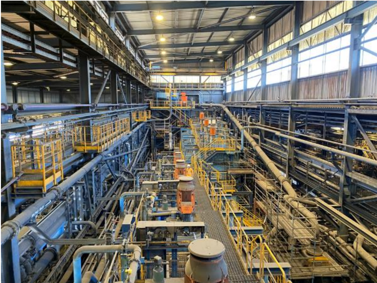
FIGURA 12: NOVAS CÉLULAS DE FLUTUAÇÃO INSTALADAS NA ATUAL LAVARIA DO ZN
