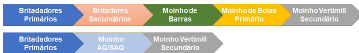
FIGURA 17: ETAPAS DE BRITAGEM E MOAGEM ATUAIS COMPARATIVAMENTE À CONFIGURAÇÃO DO PEZ
